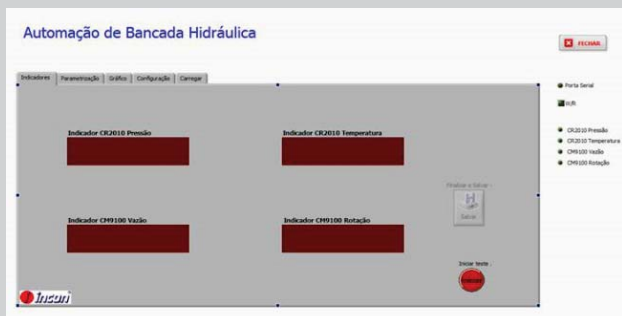
Tela inicial : Indicação das variáveis em tempo real e botão de início para as aquisições de dados.
