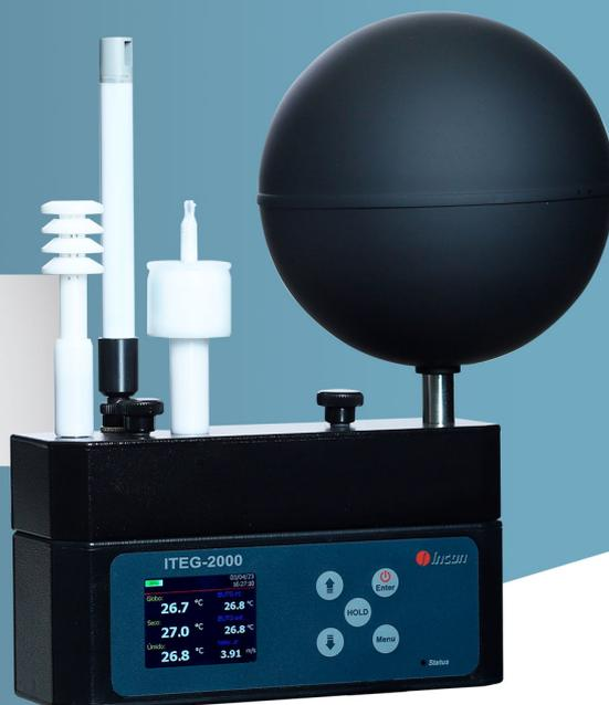
O Monitor de Calor ITEG-2000B possui uma ampla faixa de medição de temperatura, podendo ser utilizado desde baixas temperaturas até altas temperaturas, devido a sua barra de sensores ser destacável do módulo eletrônico. Tem como itens opcionais o sensor de velocidade do ar e comunicação remota por WI-FI (Bluetooth).
